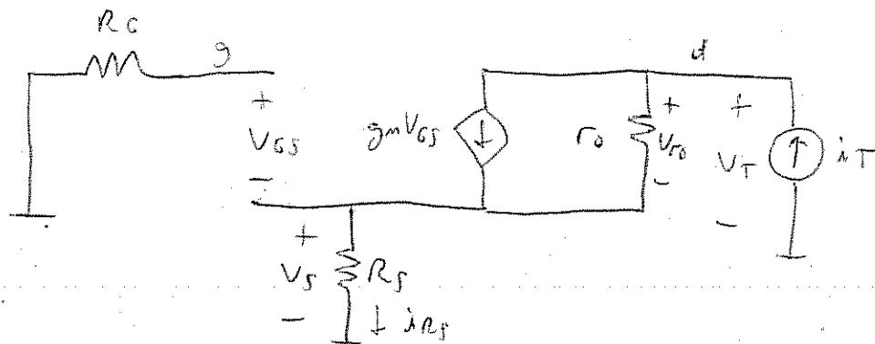
$$i_{RS} = i_T \text{ BY KCL} \Rightarrow V_S = i_T R_S$$
