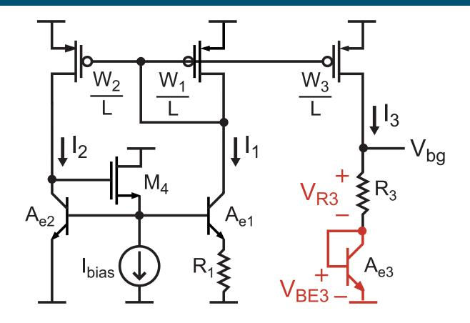
$$V_{bg} = V_{R3} + V_{BE3} \approx \frac{W_3}{W_1} \frac{R_3}{R_1} \Delta V_{BE} + V_{BE3}$$
