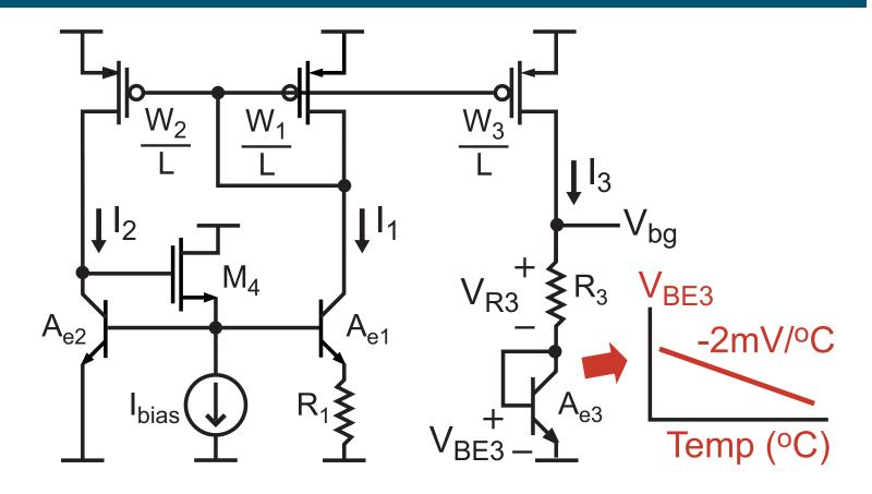
$$V_{bg} = V_{R3} + V_{BE3} \approx \frac{W_3}{W_1} \frac{R_3}{R_1} \Delta V_{BE} + V_{BE3}$$
